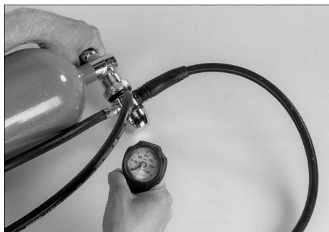
Bild 6.18 Prüfen des Flaschenvorratsdruckes
