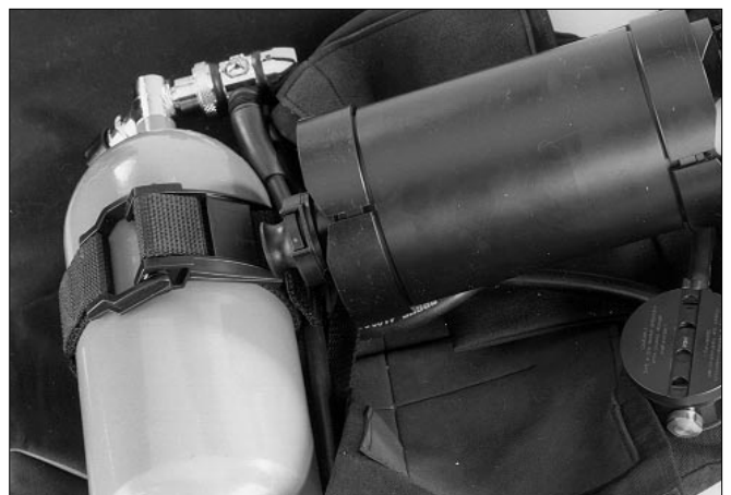
Bild 6.15 Anschließen des Kalkbehälters
