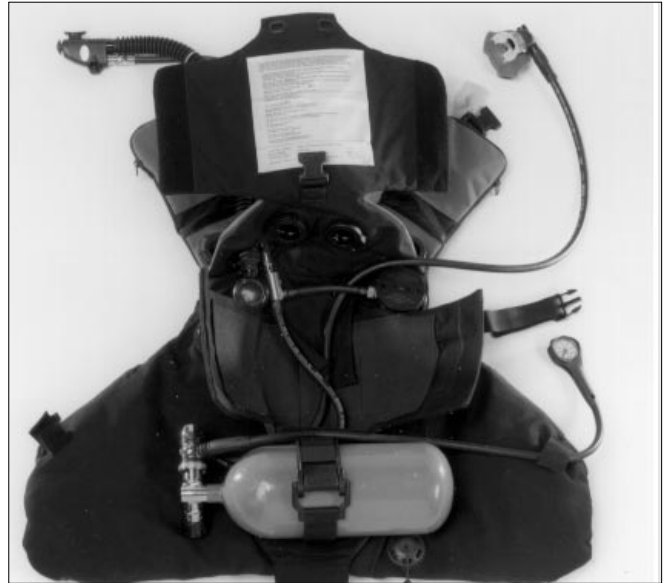
Bild 6.13 Geräterückseite mit Mischgasflasche und montierter Pneumatik
