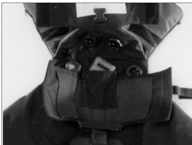
Bild 6.12 Befüllen der Trimmbleitaschen
