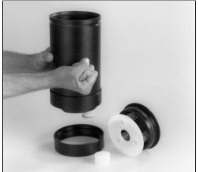
Bild 6.10 Einrütteln der Kalkfüllung
