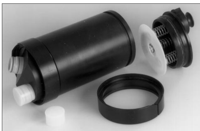
Bild 6.7 Entfernen des unteren Patronendeckels
