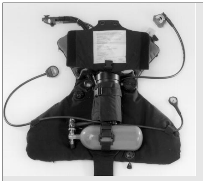
Bild 6.17 Sichern des Kalkbehälters
