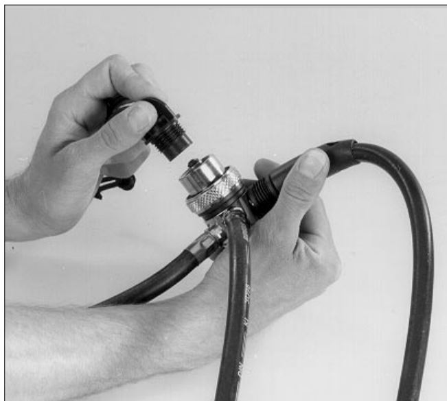
Bild 6.20 Montieren der Schutzkappe am Druckminderer
