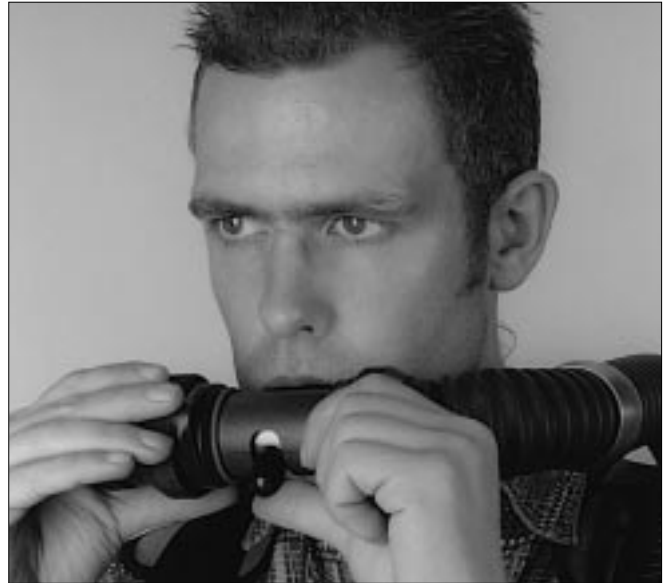
Bild 6.19 Ventilmundstück ausblasen und öffnen
